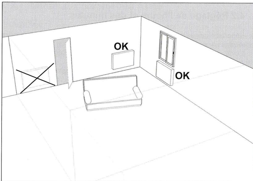
Après avoir ouvert une fenêtre, votre appareil devrait détecter la baisse de température liée à celle-ci sous 15 minutes. Il va alors adapter son mode de fonctionnement en passant automatiquement en mode hors-gel.
