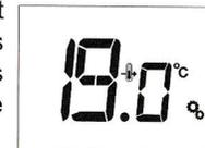
Appuyez 5 secondes sur la touche **MODE** pour accéder aux fonctions avancées. Appuyez ensuite plusieurs fois sur la touche **MODE** pour atteindre la fonction d'étalonnage du radiateur (voir le début de la section pour plus de détails).
