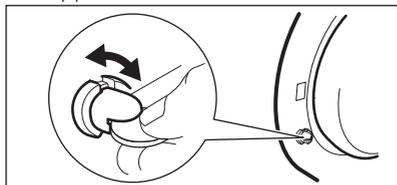
Pour fermer le couvercle, tournez le dispositif vers la gauche jusqu'à ce que la rainure soit verticale.
